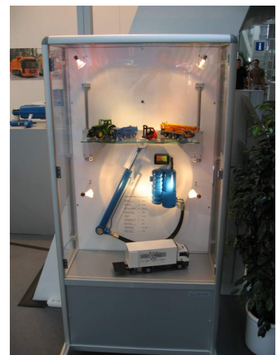
Demonstrationsprüfstand einer reversierbaren Kolbenpumpe
