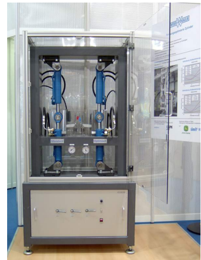
Demonstrationsprüfstand für Reibkraftoptimierte Hydrozylinder
